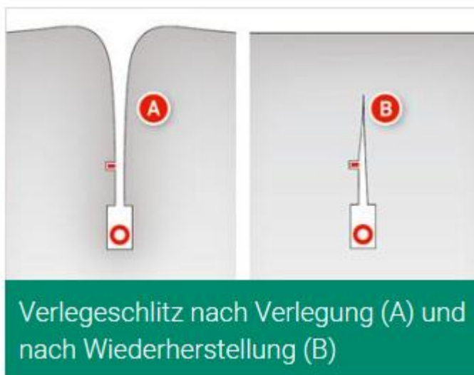
Abbildung 7: Schematischer Querschnitt einer Kabelverlegung durch Pflug 3
