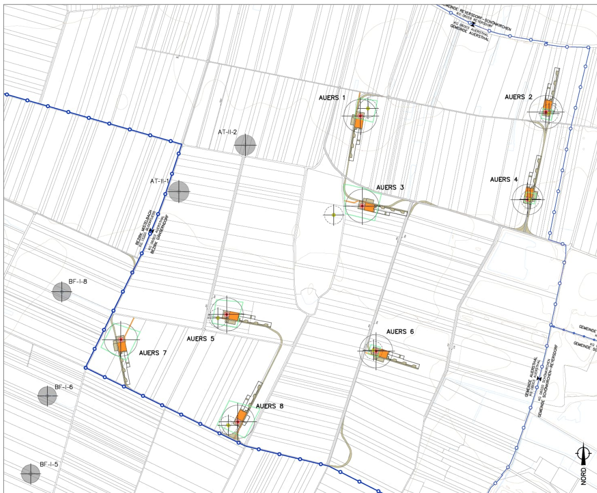
Abb 20: Lageplan mit Darstellung der internen Wegführung und der Kranstell- und Montageflächen
