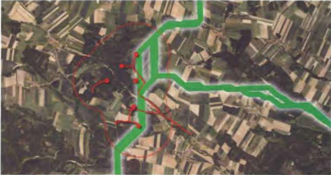
**Abb. 4:** Die WKA-Standorte des Vorhabens „Windpark Sigmundsherberg“ (●), die zu errichtenden Zufahrtsstraßen (—), der Pufferbereich von 1 km um die WKA-Mittelpunkte (-----), in dem jedenfalls mit erheblichen Störungen für Wildtiere durch die WKAs zu rechnen ist sowie die für das Vorhaben relevanten, für Österreich bedeutsamen Lebensraumkorridore (—, LEITNER 2018, BMNT).
