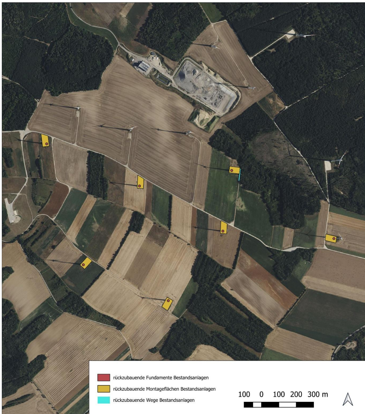
Abbildung 8: rückzubauende Flächen des Bestandwindparks Schrick II
