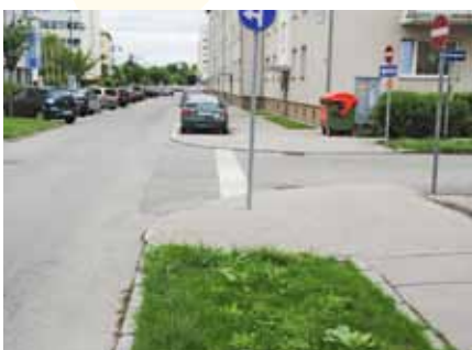
Abbildung 46: Gehsteigvorziehung im Kreuzungsbereich
