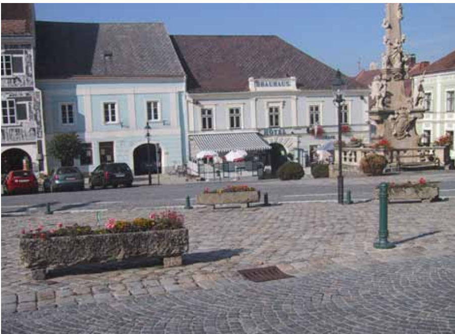
Abbildung 77: Poller und Blumentröge trennen Fahrbahn und Fußgängerbereich
