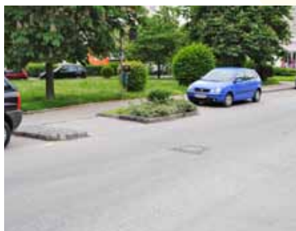
Abbildung 47: Gehsteigvorziehung im Streckenbereich
