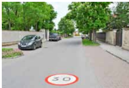
Abbildung 33: Unterschiedliche Gestaltungen der Nebenflächen und der Fahrbahn, eine Begrünung und Unterteilung der Stellplatzreihen unterstützt die Verordnung von Tempo-30
