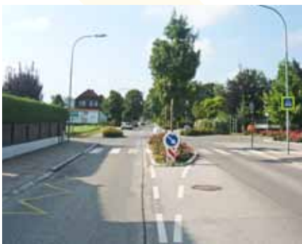
Abbildung 44: Querungshilfe als Fahrbahnteiler und mit Schutzweg
